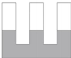
В сосуде, показанном на рисунке, находится ртуть. Горизонтальные сечения трубок одинаковы. В левую трубку налили воду, высота столба которой  $h = 80$  мм, а в правую – масло, образовавшее столб некоторой высоты  $h_0$ . После этого в средней трубке уровень ртути поднялся на  $\Delta h = 5$  мм. Найдите высоту  $h_0$  столба масла, налитого в правую трубку. Плотность воды  $\rho = 1000$  кг/м<sup>3</sup>, масла –  $\rho_0 = 800$  кг/м<sup>3</sup> и ртути –  $\rho_1 = 13600$  кг/м<sup>3</sup> [9]
