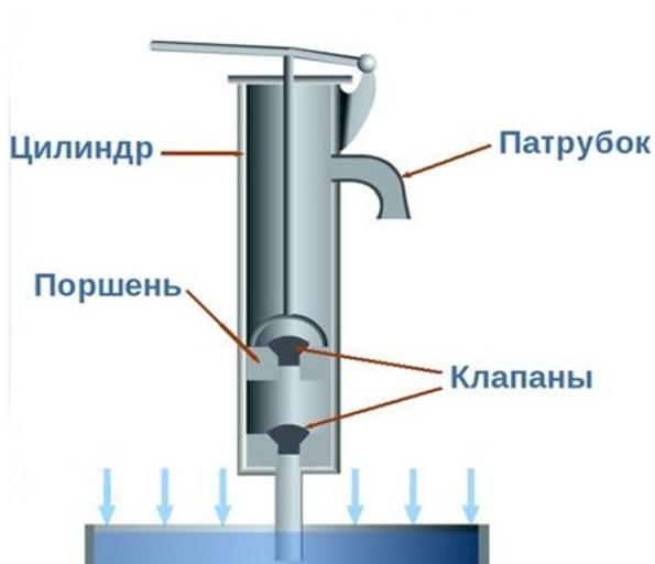
*Рис. 9. Воздушный поршневой насос*
