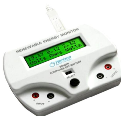
Рисунок 4 – Мульти метр для измерения силы тока, напряжения и мощности лабораторных альтернативных источников энергии
