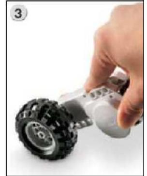
Прокатив колесо по поверхности стола, запишите измеренное число оборотов. Если теперь умножить полученное число на  $D$ , где  $D$  – диаметр колеса, можно узнать пройденное расстояние.
