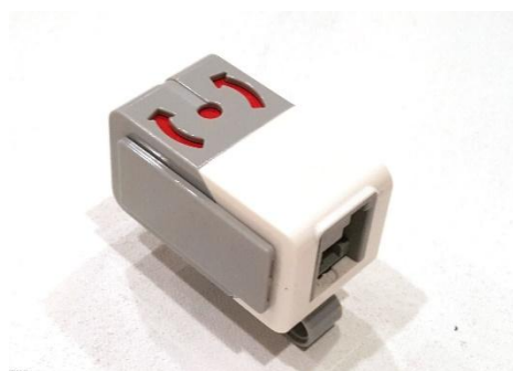
Рис. 11. Гироскопический датчик комплекта Lego Mindstorms EV3
