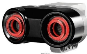
Рис. 9. Ультразвуковой датчик комплекта Lego Mindstorms EV3
