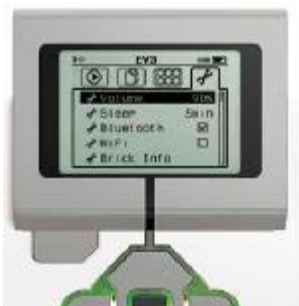
Рис. 5. Экран настройки параметров модуля EV3
