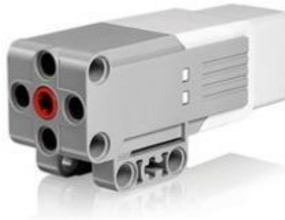
Рис. 7. Средний мотор комплекта Lego Mindstorms EV3
