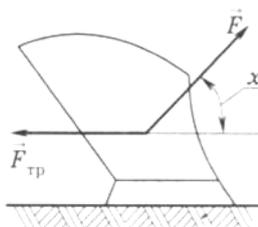
Рис. 10. Прицепной плуг
