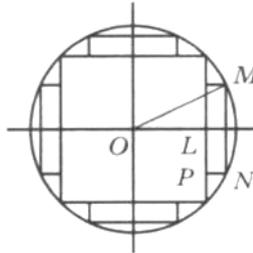
Рис. 13. Распиливание бревна на брус и доски
