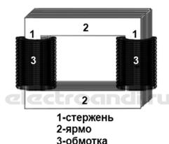
**Броневой трансформатор** представляет собой ярмо внутри которого заключается стержень с обмоткой. Ярмо как бы защищает стержень, поэтому трансформатор называется броневым.
