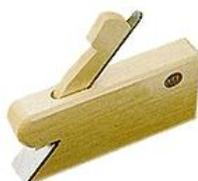
**Грунтубель** - профильное строгание. Для выборки трапециевидного паза («ласточкин хвост») или зачистки поперек волокон таких пазов, выбранных с помощью ножовки-наградки или стамески.
