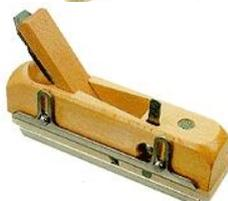
**Отборник** - профильное строгание. Для прямоугольной обработки кромок, вы сборки и разработки четвертей.
