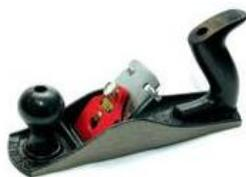
**Шлифтик** - плоское строгание. Для окончательной зачистки торцов, древесины со свилеватостью и задирами.
