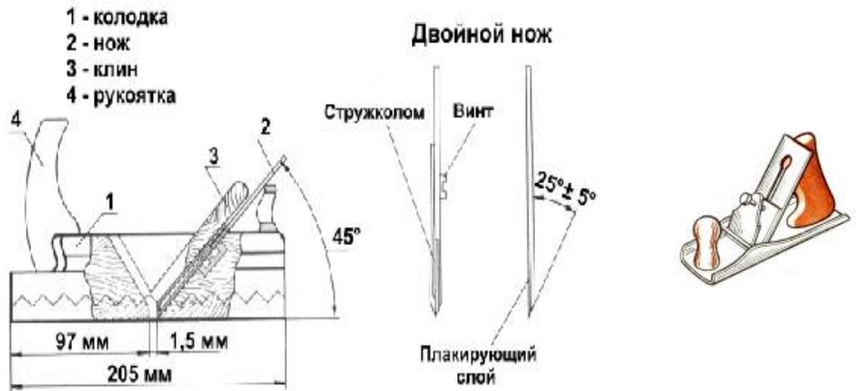
Нож рубанка (как и режущая часть всех столярных инструментов) в своей режущей части затачивается в виде острого клина. Две поверхности клина на своем пересечении образуют острую режущую кромку. Эта режущая кромка разрезает волокна древесины, а передняя поверхность ножа отгибает срезанный слой в виде стружки.
