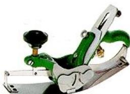
**Гобрач** - строгание криволинейных поверхностей. Для ручного строгания выпуклых и вогнутых деталей. Выпуклую поверхность строгают горбачом с вогнутой подошвой, а вогнутую поверхность — горбачом с выпуклой подошвой.
