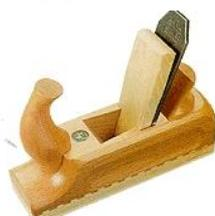
**Цинубель** - плоское строгание. Для рифления поверхностей, необходимого при фанеровании и при склеивании очень твердых пород древесины. Используют при строгании свилеватой поверхности твердых пород (красное и особенно черное дерево).
