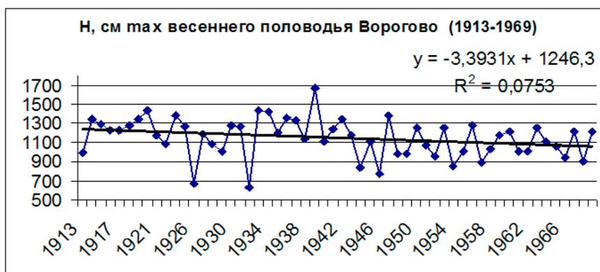
Рис. 4. Временной ход максимальных уровней воды весеннего половодья до строительства ГЭС
