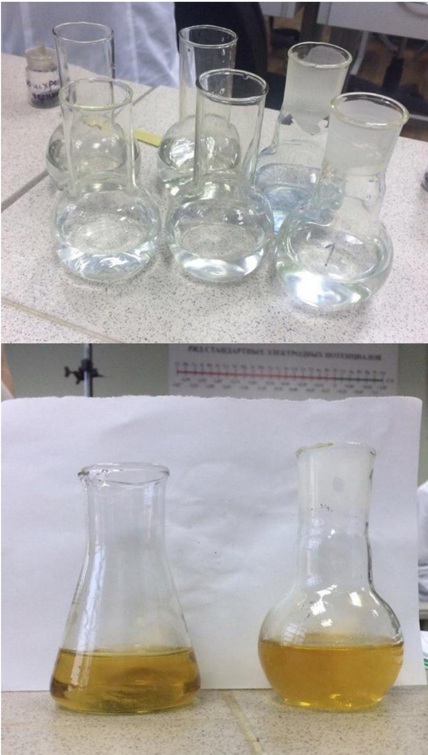
Йодометрическое определение содержания кислорода
