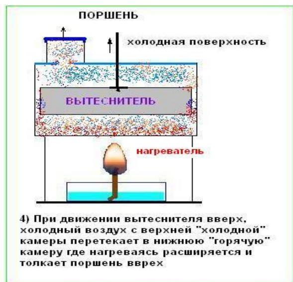
Если синхронизировать движение вытеснителя и поршня со смещением в 90 градусов (используя коленвал) получим циклические движения поршня и вытеснителя которые в нашем случае раскручивают маховик
