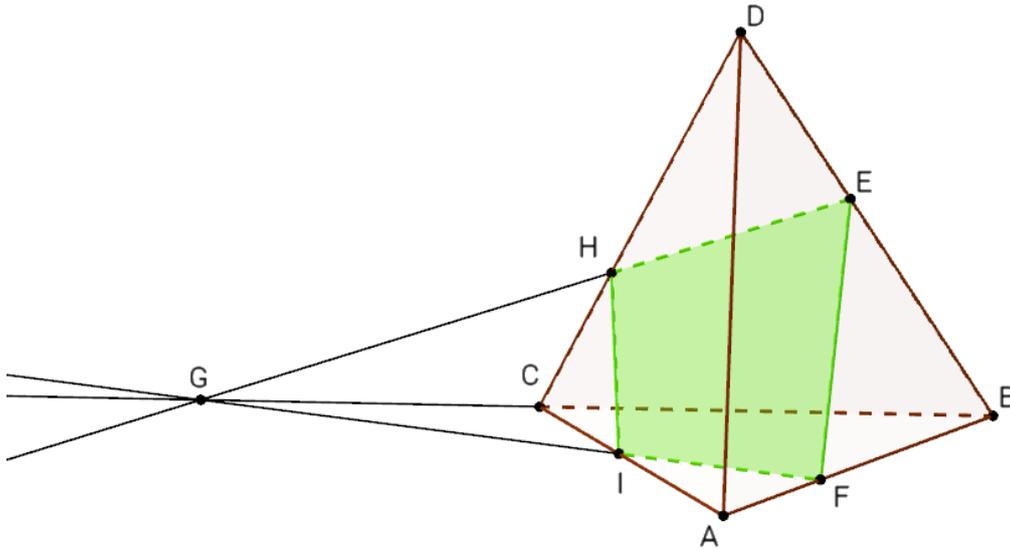
Рисунок 16: Сечение тетраэдра – четырёхугольник
