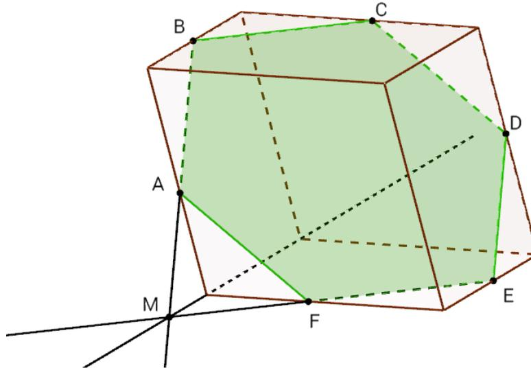
Рисунок 20: Сечение параллелепипеда. ABCDEF – шестиугольник
