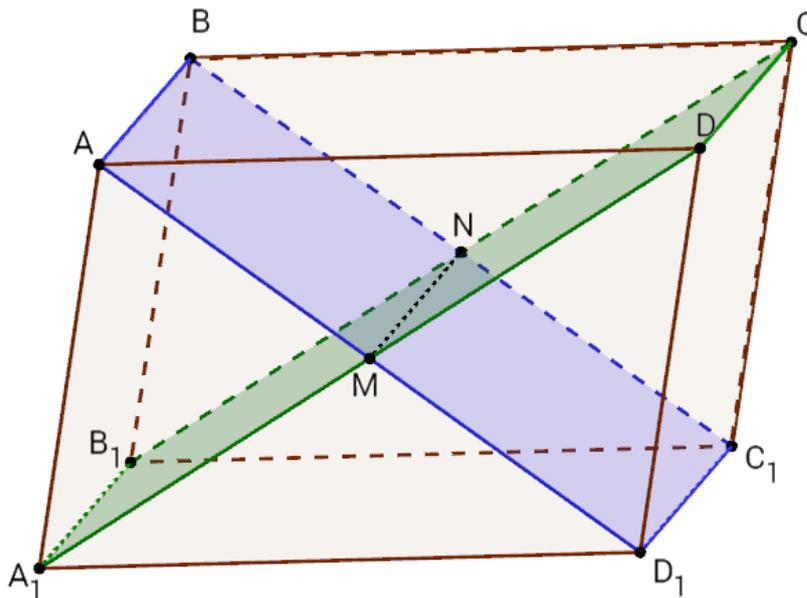
Рисунок 35: Построение линии пересечения двух сечений параллелепипеда
