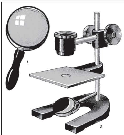
Рис. 1. Лупы ручная (1) и штативная (2)
