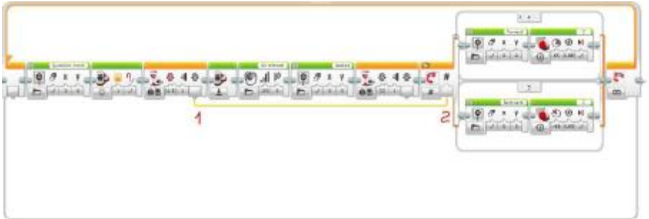
Рис. 68. Устанавливаем соединение между блоками
