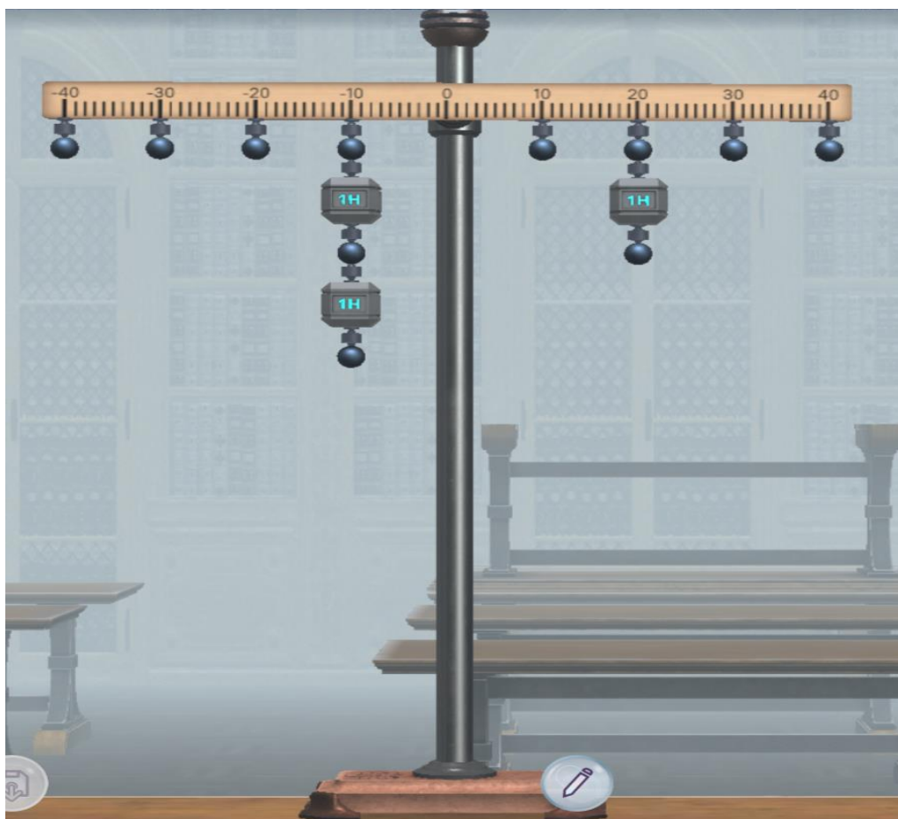
Рисунок 10. Рычаг-линейка в равновесии, с подвешенными на него по обе стороны от оси вращения грузиками 1 Н
