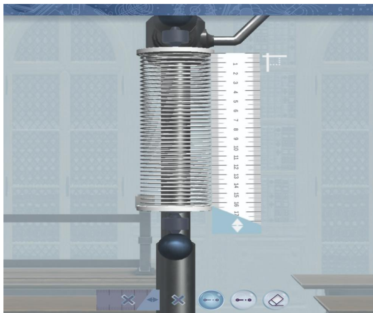
Рисунок 5. Измерение линейкой начальной длины пружины
