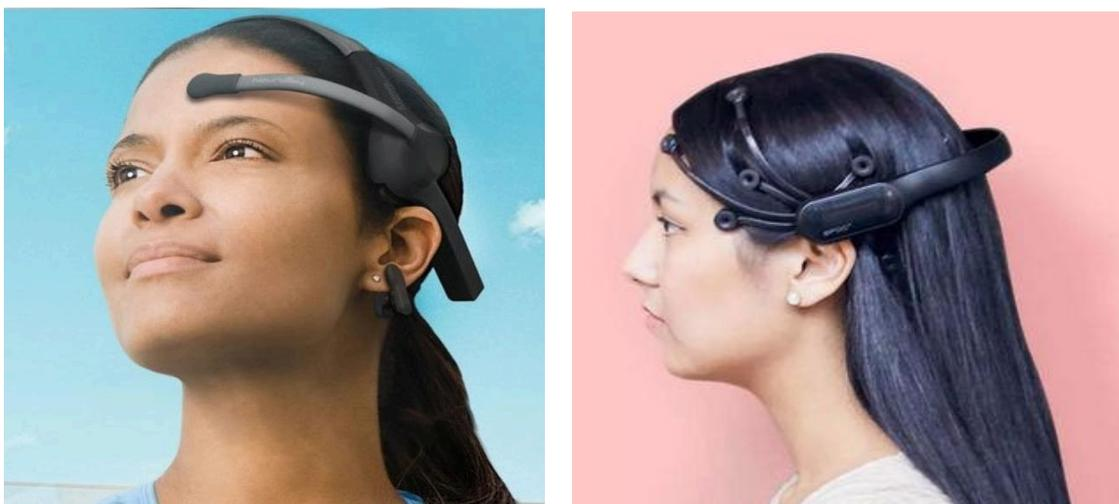
Рисунок 11 – Нейрогарнитуры: Neurosky MindWave Mobile (3 электрода) – слева; Emotive Epos (14 электродов) – справа [Нейрогарнитура... 2025].
