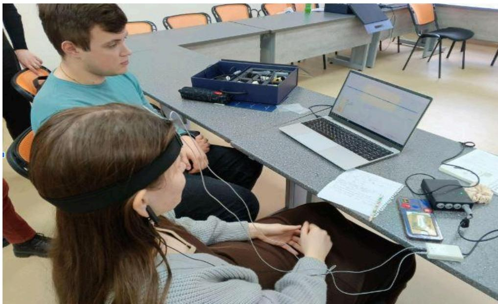
Рисунок 13 – Процесс записи ЭЭГ с нейрогарнитурой ViTronics
