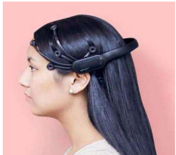
Рисунок 11 – Нейрогарнитуры: Neurosky MindWave Mobile (3 электрода) – слева ; Emotive Eroc (14 электродов) – справа [Нейрогарнитура... 2025].
