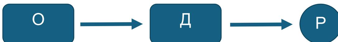
Рисунок 7. Блок-схема автоматического устройства контроля (О — контролируемый объект, Д — датчик, Р — регистрирующее устройство: лампочка, сирена, звонок, измерительный прибор и т.д.)
