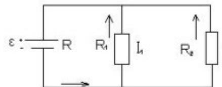
3. Найти э. д. с. и внутреннее сопротивление источника, эквивалентного двум параллельно соединенным элементам с э. д. с.  $\xi_1$  и  $\xi_2$  и внутренними сопротивлениями  $R_1$  и  $R_2$ .
