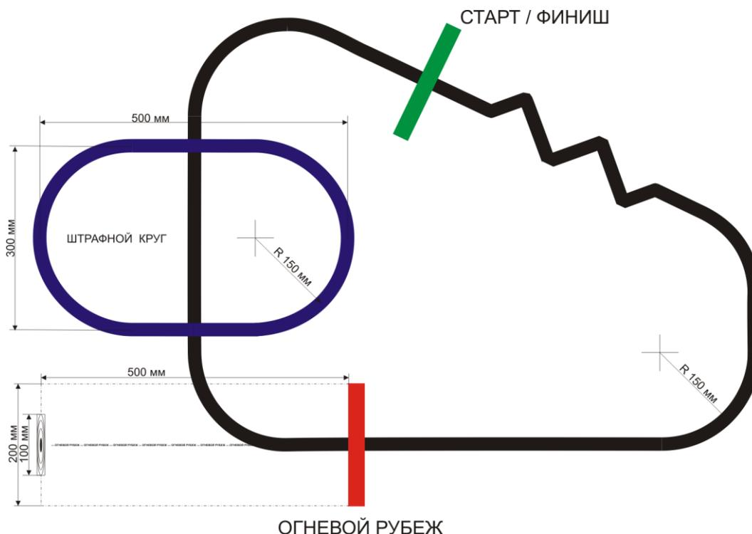
Основной круг представляет собой сплошную черную линию шириной 20 мм. Линия состоит из прямых, изогнутых и ломаных фрагментов. Радиус закругления изогнутых участков не менее 150 мм, угол поворота ломаной – 90°. Основной круг пересекают две линии длиной 200 мм и шириной 20 мм,
