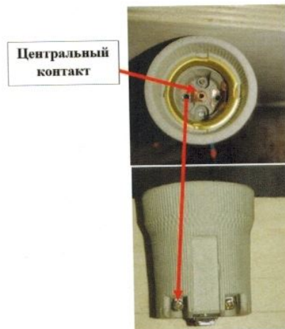
Рис. 4 Пример, как определить центральный контакт по расположению контактных винтов.
