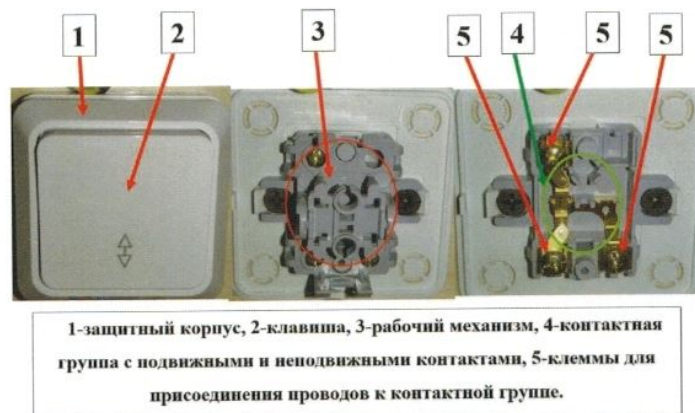
Рис. 1 Устройство одинарного переключателя.
