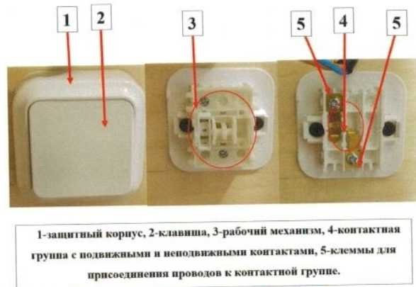
Рис. 3 Устройство одноклавишного выключателя.
