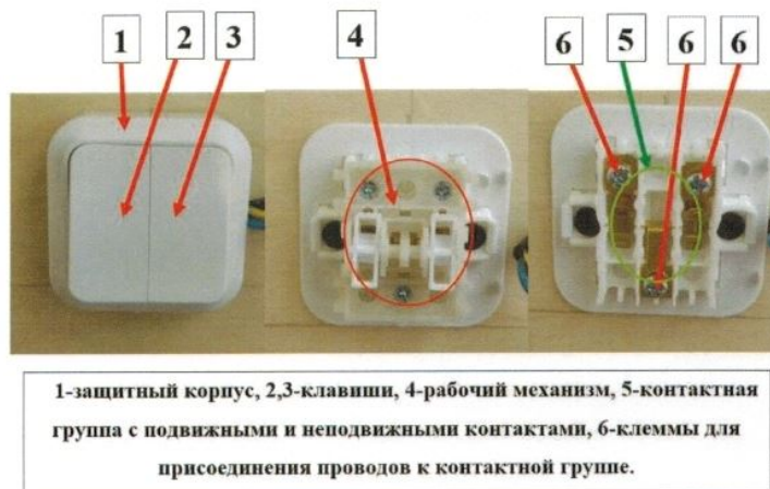
Рис. 1 Устройство двухклавишного выключателя.
