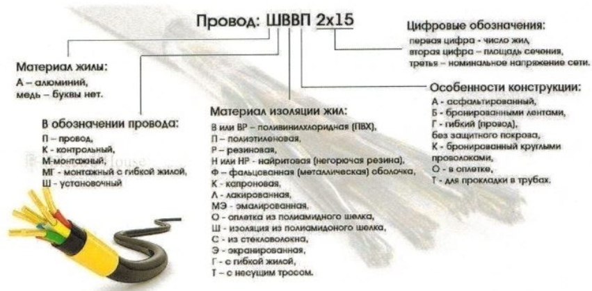
Рис. 6 Маркировка проводов и кабелей.
