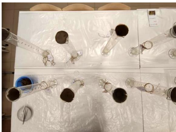
*Рис. 2. Твердый осадок на фильтрах*
