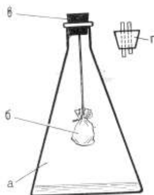
Рис. 36. Прибор для определения дыхания: а – колба со щелочью; б – марлевый мешочек с проростками; в – пробка; г – пробка со стеклянными трубками (используется при титровании)
