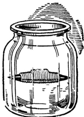
Постепенно сматывая проволоку и отрезая по кусочку, добейся, чтобы лодка "висела" между дном и поверхностью воды. Вот теперь она действительно подводная!
