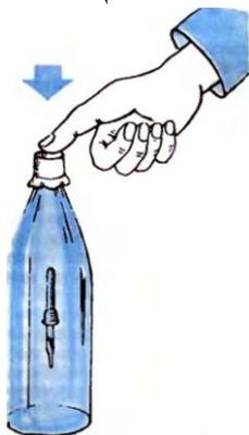
Дело в том, что мы немного сжали воздух в горлышке бутылки и это давление передалось воде. Вода проникла в пипетку - она стала тяжелее и утонула. При прекращении давления сжатый воздух внутри пипетки удалил лишнюю воду, наш водолаз" стал легче и всплыл. Если в начале опыта "водолаз" вас не слушается, значит, надо отрегулировать начальное количество воды в пипетке.
