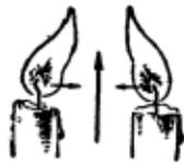
Подуйте в промежуток между ними. Пламя свечей наклонится друг к другу. Это происходит потому, что струя воздуха проходит между свечами и создает в этом промежутке пониженное давление, а воздух, устремляясь сюда с правой и левой стороны, наклонит языки пламени.
