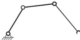
Рисунок 11- Кинематическая цепь, присоединенная к стойке
