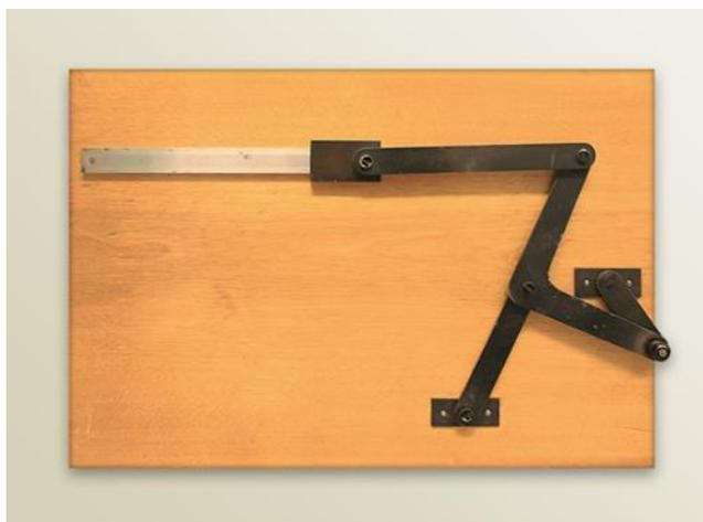
*Рисунок 6-Механизм для преобразования вращательного движения в поступательное с ускоренным обратным ходом*
