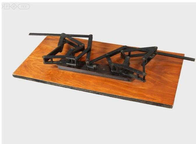
*Рисунок 5-Гребной механизм*
