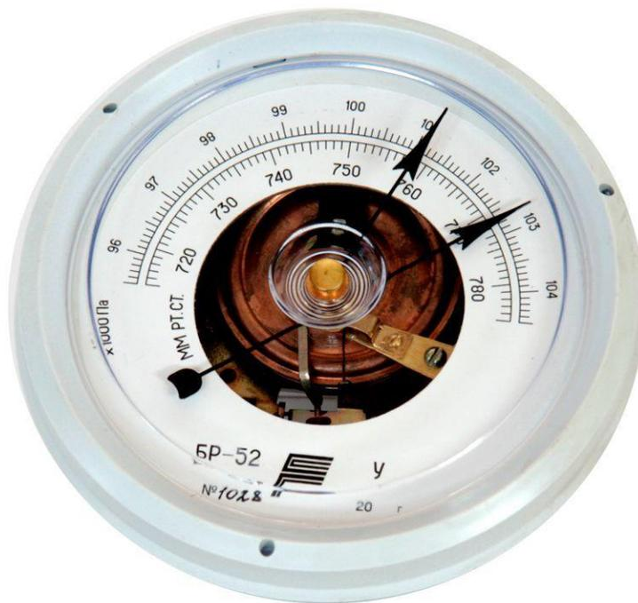
Рисунок 12. Барометр
