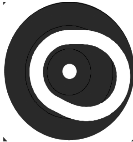
Рис. 4. Практический профиль пазового кулачка
