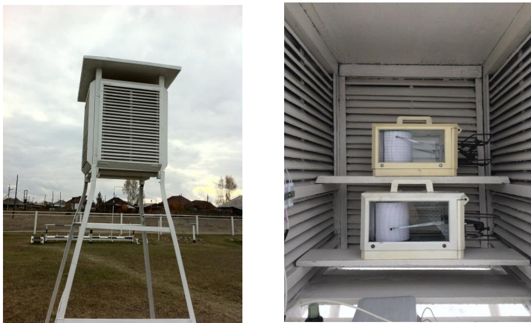
Рис. 4. Психрометрическая будка с приборами-самописцами [24].
