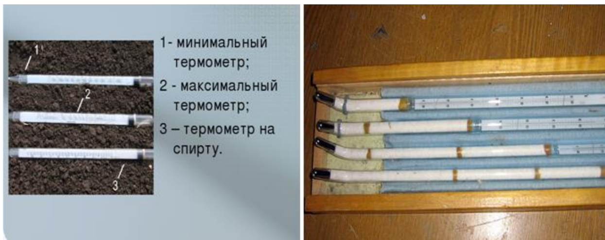
Рис. 5. Напочвенные и вытяжные термометры [24].
