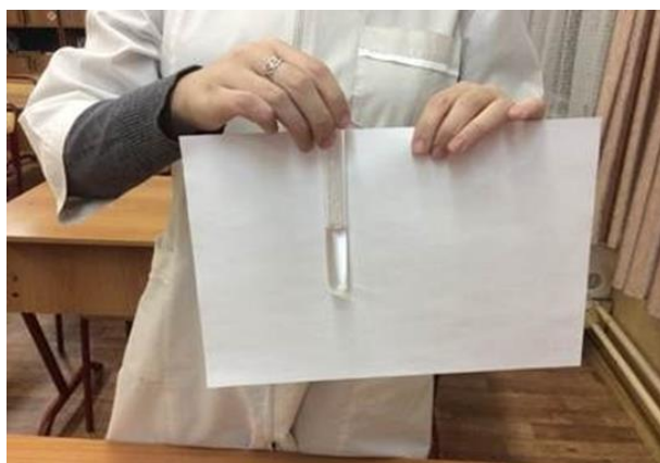
Рис.7. Определение прозрачности воды
