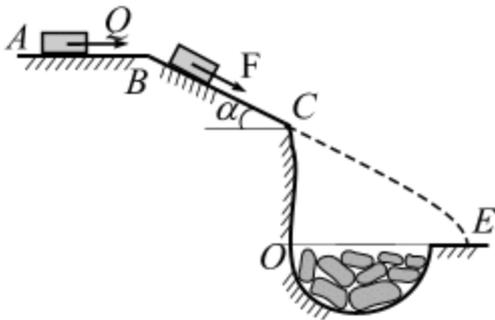
**Вариант 24.** Груз массой  $m = 8$  кг, получив в точке  $A$  начальную скорость  $V_0 = 3$  м/с, движется по поверхности  $ABC$ , расположенной в вертикальной плоскости. В точке  $C$  груз покидает поверхность, и в точке  $E$  падает на край оврага. Угол  $\alpha = 32^\circ$ . Движение груза разбито на три участка.
