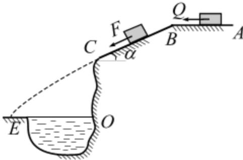
**Вариант 21.** Тело массой  $m = 6$  кг, получив в точке  $A$  начальную скорость  $V_0 = 9$  м/с, движется по поверхности  $ABC$ . В точке  $C$  тело покидает поверхность, и в точке  $E$  падает на берег рва. Угол  $\alpha = 30^\circ$ . Движение тела разбито на три участка.
