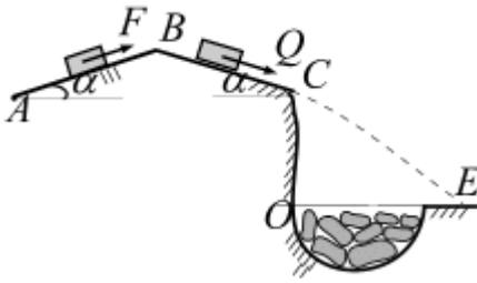
**Вариант 12.** Груз массой  $m = 8$  кг, получив в точке  $A$  начальную скорость  $V_0 = 8$  м/с, движется по поверхности  $ABC$ , расположенной в вертикальной плоскости. В точке  $C$  груз покидает поверхность, и в точке  $E$  падает на край оврага. Угол  $\alpha = 23^\circ$ . Движение груза разбито на три участка.
