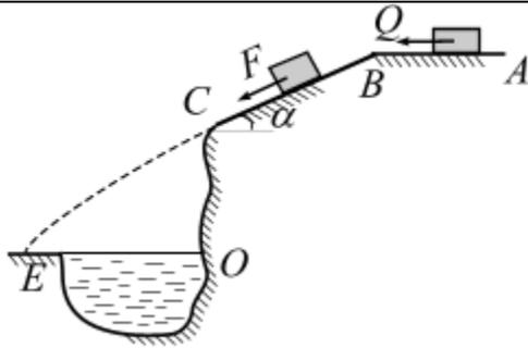
**Вариант 18.** Тело массой  $m = 6$  кг, получив в точке  $A$  начальную скорость  $V_0 = 10$  м/с, движется по поверхности  $ABC$ . В точке  $C$  тело покидает поверхность, и в точке  $E$  падает на берег рва. Угол  $\alpha = 22^\circ$ . Движение тела разбито на три участка.
