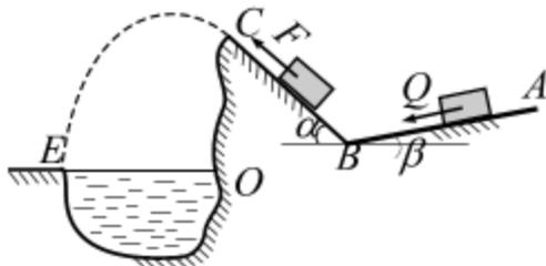
**Вариант 19.** Тело массой  $m = 6$  кг, получив в точке  $A$  начальную скорость  $V_0 = 5$  м/с, движется по поверхности  $ABC$ . В точке  $C$  тело покидает поверхность, и в точке  $E$  падает на берег рва. Угол  $\beta = 20^\circ$ ;  $\alpha = 30^\circ$ . Движение тела разбито на три участка.
