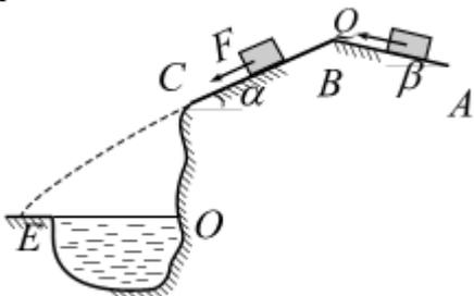
**Вариант 20.** Тело массой  $m = 6$  кг, получив в точке  $A$  начальную скорость  $V_0 = 6$  м/с, движется по поверхности  $ABC$ . В точке  $C$  тело покидает поверхность, и в точке  $E$  падает на берег рва. Угол  $\beta = 18^\circ$ ;  $\alpha = 25^\circ$ . Движение тела разбито на три участка.
