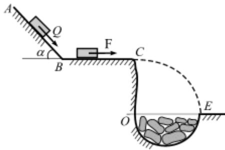
**Вариант 8.** Груз массой  $m = 8$  кг, получив в точке  $A$  начальную скорость  $V_0 = 3$  м/с, движется по поверхности  $ABC$ , расположенной в вертикальной плоскости. В точке  $C$  груз покидает поверхность, и в точке  $E$  падает на край оврага. Угол  $\alpha = 28^\circ$ . Движение груза разбито на три участка.
