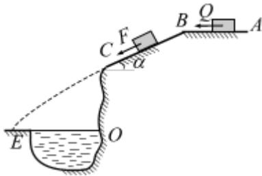
**Вариант 4.** Тело массой  $m = 6$  кг, получив в точке  $A$  начальную скорость  $V_0 = 6$  м/с, движется по поверхности  $ABC$ . В точке  $C$  тело покидает поверхность, и в точке  $E$  падает на берег рва. Угол  $\alpha = 22^\circ$ . Движение тела разбито на три участка.
