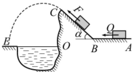
**Вариант 1.** Тело массой  $m = 6$  кг, получив в точке  $A$  начальную скорость  $V_0 = 4$  м/с, движется по поверхности  $ABC$ . В точке  $C$  тело покидает поверхность, и в точке  $E$  падает на берег рва. Угол  $\alpha = 35^\circ$ . Движение тела разбито на три участка.
