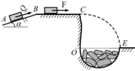
**Вариант 23.** Груз массой  $m = 8$  кг, получив в точке  $A$  начальную скорость  $V_0 = 3$  м/с, движется по поверхности  $ABC$ , расположенной в вертикальной плоскости. В точке  $C$  груз покидает поверхность, и в точке  $E$  падает на край оврага. Угол  $\alpha = 18^\circ$ . Движение груза разбито на три участка.
