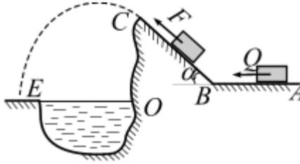
**Вариант 14.** Груз массой  $m = 8$  кг, получив в точке  $A$  начальную скорость  $V_0 = 3$  м/с, движется по поверхности  $ABC$ , расположенной в вертикальной плоскости. В точке  $C$  груз покидает поверхность, и в точке  $E$  падает на край оврага. Движение груза разбито на три участка.
