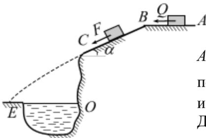
**Вариант 26.** Тело массой  $m = 6$  кг, получив в точке  $A$  начальную скорость  $V_0 = 6$  м/с, движется по поверхности  $ABC$ . В точке  $C$  тело покидает поверхность, и в точке  $E$  падает на берег рва. Угол  $\alpha = 22^\circ$ . Движение тела разбито на три участка.
