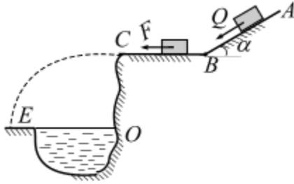
**Вариант 25.** Тело массой  $m = 9$  кг, получив в точке  $A$  начальную скорость  $V_0 = 2$  м/с, движется по поверхности  $ABC$ . В точке  $C$  тело покидает поверхность, и в точке  $E$  падает на берег рва. Угол  $\alpha = 15^\circ$ . Движение тела разбито на три участка.
