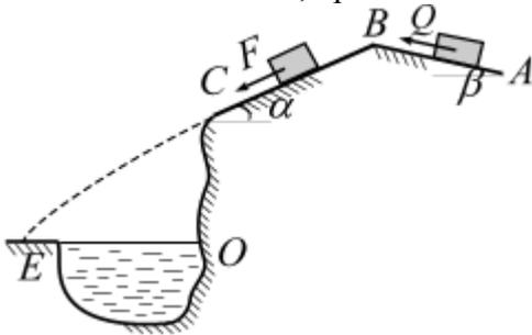
**Вариант 6.** Тело массой  $m = 6 \text{ кг}$ , получив в точке  $A$  начальную скорость  $V_0 = 5 \text{ м/с}$ , движется по поверхности  $ABC$ . В точке  $C$  тело покидает поверхность, и в точке  $E$  падает на берег рва. Угол  $\beta = 18^\circ$ ;  $\alpha = 25^\circ$ . Движение тела разбито на три участка.
