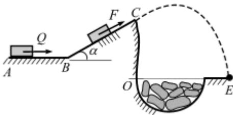
**Вариант 13.** Груз массой  $m = 8$  кг, получив в точке  $A$  начальную скорость  $V_0 = 3$  м/с, движется по поверхности  $ABC$ , расположенной в вертикальной плоскости. В точке  $C$  груз покидает поверхность, и в точке  $E$  падает на край оврага. Угол  $\alpha = 26^\circ$ . Движение груза разбито на три участка.
