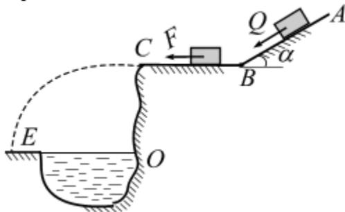
**Вариант 17.** Тело массой  $m = 6 \text{ кг}$ , получив в точке  $A$  начальную скорость  $V_0 = 5 \text{ м/с}$ , движется по поверхности  $ABC$ . В точке  $C$  тело покидает поверхность, и в точке  $E$  падает на берег рва. Угол  $\alpha = 25^\circ$ . Движение тела разбито на три участка.
