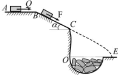
**Вариант 10.** Груз массой  $m = 8$  кг, получив в точке  $A$  начальную скорость  $V_0 = 4$  м/с, движется по поверхности  $ABC$ , расположенной в вертикальной плоскости. В точке  $C$  груз покидает поверхность, и в точке  $E$  падает на край оврага. Угол  $\alpha = 32^\circ$ . Движение груза разбито на три участка.
