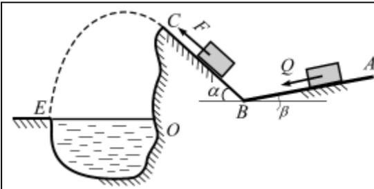
**Вариант 27.** Тело массой  $m = 6$  кг, получив в точке  $A$  начальную скорость  $V_0 = 4$  м/с, движется по поверхности  $ABC$ . В точке  $C$  тело покидает поверхность, и в точке  $E$  падает на берег рва. Угол  $\beta = 20^\circ$ ;  $\alpha = 30^\circ$ . Движение тела разбито на три участка.
