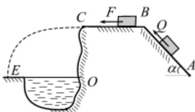
**Вариант 2.** Тело массой  $m = 4$  кг, получив в точке  $A$  начальную скорость  $V_0 = 5$  м/с, движется по поверхности  $ABC$ . В точке  $C$  тело покидает поверхность, и в точке  $E$  падает на берег рва. Угол  $\alpha = 28^\circ$ . Движение тела разбито на три участка.
