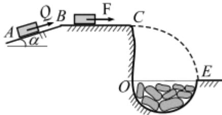
**Вариант 9.** Груз массой  $m = 8$  кг, получив в точке  $A$  начальную скорость  $V_0 = 3$  м/с, движется по поверхности  $ABC$ , расположенной в вертикальной плоскости. В точке  $C$  груз покидает поверхность, и в точке  $E$  падает на край оврага. Угол  $\alpha = 18^\circ$ . Движение груза разбито на три участка.
