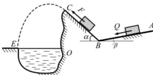
**Вариант 5.** Тело массой  $m = 6$  кг, получив в точке  $A$  начальную скорость  $V_0 = 4$  м/с, движется по поверхности  $ABC$ . В точке  $C$  тело покидает поверхность, и в точке  $E$  падает на берег рва. Угол  $\beta = 20^\circ$ ;  $\alpha = 30^\circ$ . Движение тела разбито на три участка.
