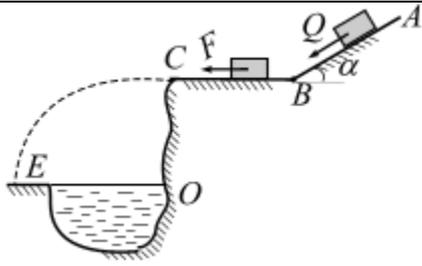
**Вариант 3.** Тело массой  $m = 6$  кг, получив в точке  $A$  начальную скорость  $V_0 = 5$  м/с, движется по поверхности  $ABC$ . В точке  $C$  тело покидает поверхность, и в точке  $E$  падает на берег рва. Угол  $\alpha = 25^\circ$ . Движение тела разбито на три участка.
