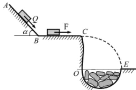
**Вариант 22.** Груз массой  $m = 8$  кг, получив в точке  $A$  начальную скорость  $V_0 = 3$  м/с, движется по поверхности  $ABC$ , расположенной в вертикальной плоскости. В точке  $C$  груз покидает поверхность, и в точке  $E$  падает на край оврага. Угол  $\alpha = 28^\circ$ . Движение груза разбито на три участка.
