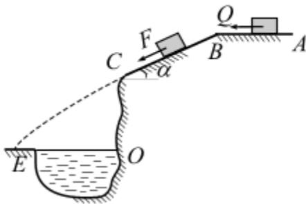
**Вариант 15.** Тело массой  $m = 6$  кг, получив в точке  $A$  начальную скорость  $V_0 = 10$  м/с, движется по поверхности  $ABC$ . В точке  $C$  тело покидает поверхность, и в точке  $E$  падает на берег рва. Угол  $\alpha = 25^\circ$ . Движение тела разбито на три участка.
