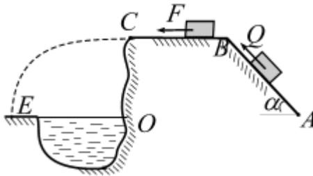
**Вариант 16.** Тело массой  $m = 4 \text{ кг}$ , получив в точке  $A$  начальную скорость  $V_0 = 10 \text{ м/с}$ , движется по поверхности  $ABC$ . В точке  $C$  тело покидает поверхность, и в точке  $E$  падает на берег рва. Угол  $\alpha = 18^\circ$ . Движение тела разбито на три участка.
