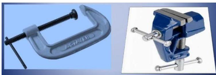
Рис. 8 Винтовой механизм
