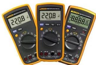
получившим название — мультиметр. Мультиметр в первую очередь предназначен для измерения напряжения, тока и сопротивления в цепи и в ее отдельных узлах.
