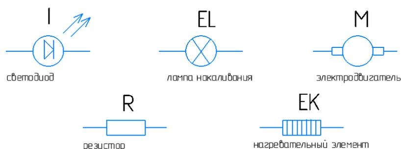
Рис.3 Электрические приемники
