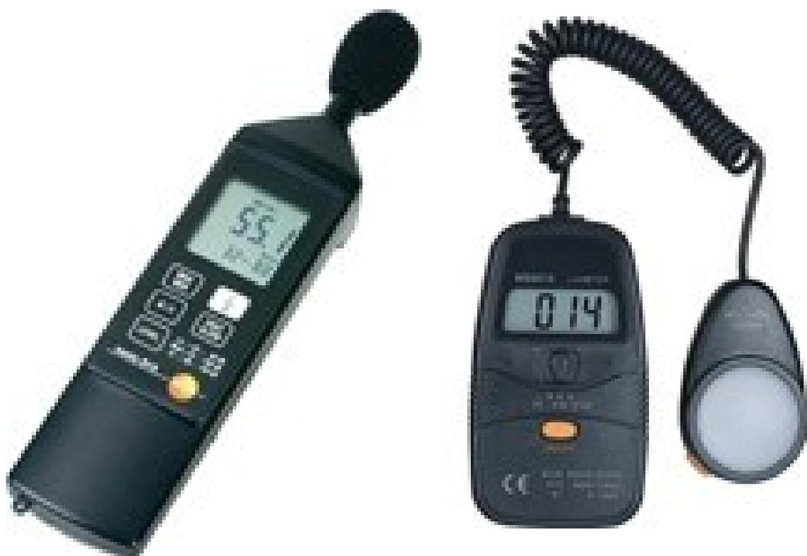
Рисунок 7. Приборы Шумомер и Люксметр
