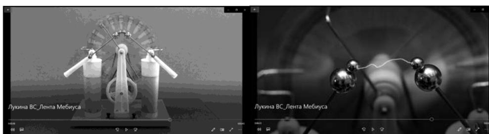
Рис. 13. Электрофорная машина
