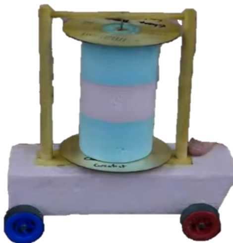
Рис.10. Модель судна Флеттнера на колесах.
