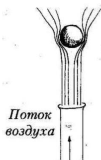
Рис. 18. Окутывание шарика потоком воздуха.
