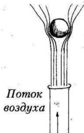
Рис.7. Окутывание шарика потоком воздуха
