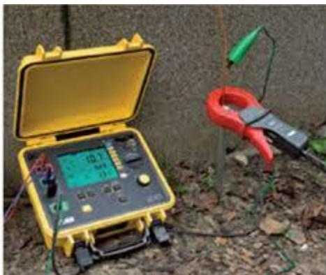
*Рис.1 Измерение сопротивления грунта.*
