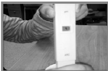
Рис. 2. Измерение кислотности снега рН-метром
